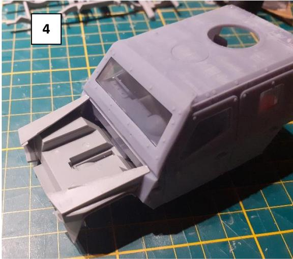
4 – Bodenplatte mit Kotflügel zuerst anheben und evtl. Korrekturen durchführen. Die Zelle hat kleine Einkerbungen in die der Kotflügel „eingeschoben“ wird. Die Stege für die Motorhaube an dem Kotflügel entfernen. Wenn alles passt, alle teile miteinander verbinden
