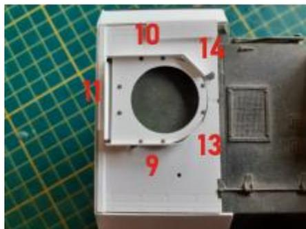
Zuerst Bauteil 9 und 10 anbringen. Bauteil 11 schräg passend anbringen (siehe Bild Krähennest)
